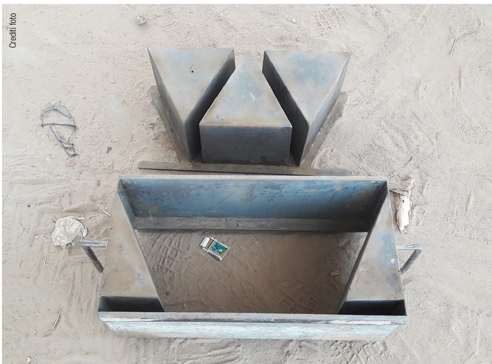
Bambej University: gli strumenti utilizzati dalla popolazione locale, per la produzione in opera dei breve block in cemento
